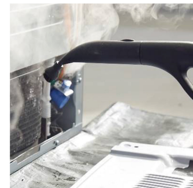
蒸氣清潔冷凝器
