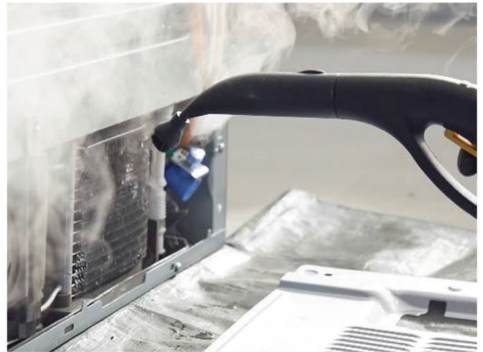
蒸氣清潔冷凝器
